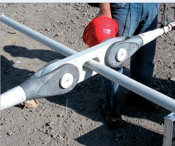
Křížení táhel průměru 45 mm a akcelerometry
