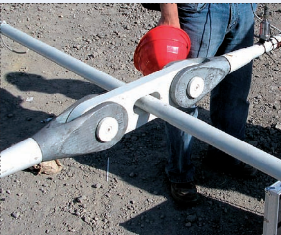
Křížení táhel průměru 45 mm a akcelerometry
