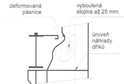
Obr. 5. Lokální deformace sloupů v řadě D
