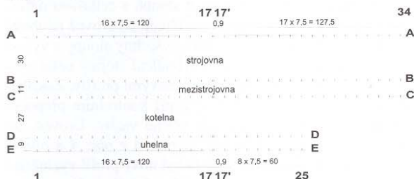
Obr. 1. Půdorys hlavního výrobního objektu
