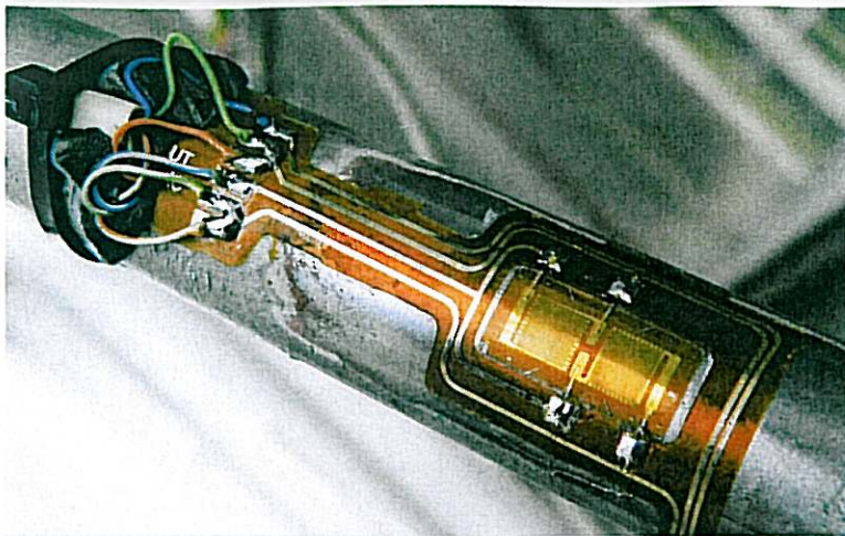
▲ Zapojení tenzometru na táhla
