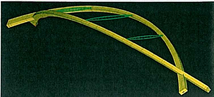
Obr. 6 – Schéma postupné montáže hlavních oblouků.
