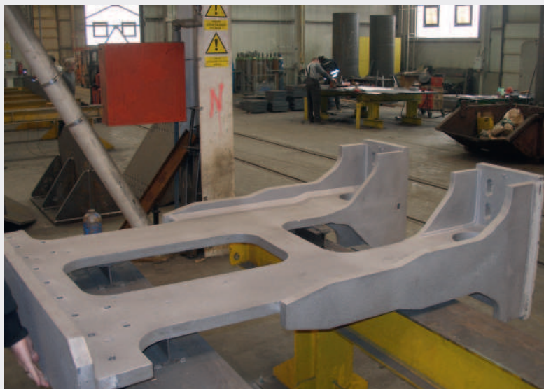
▼ Obr. 12. Kotevní prvek připraven pro zabetonování do příčnický
