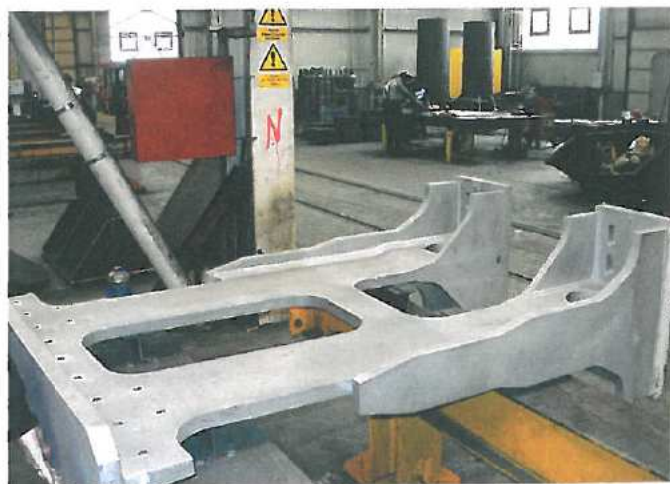
Ryc. 13. Element kotwiący przygotowany do zabetonowania w poprzecznic
