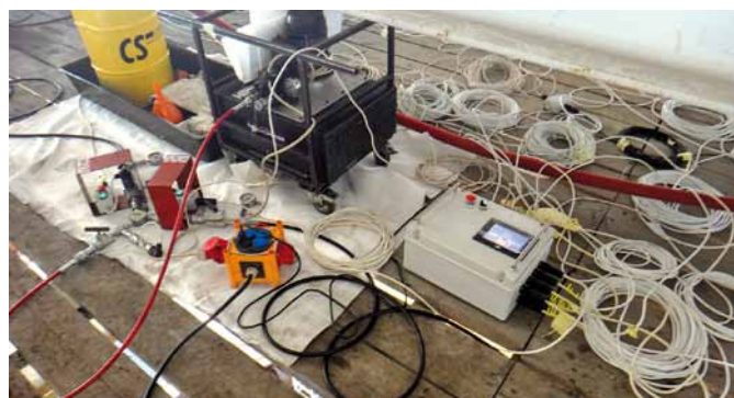
Řídicí stanoviště bylo vybaveno přenosným synchronním systémem s 16 vstupy a 8 výstupy.
