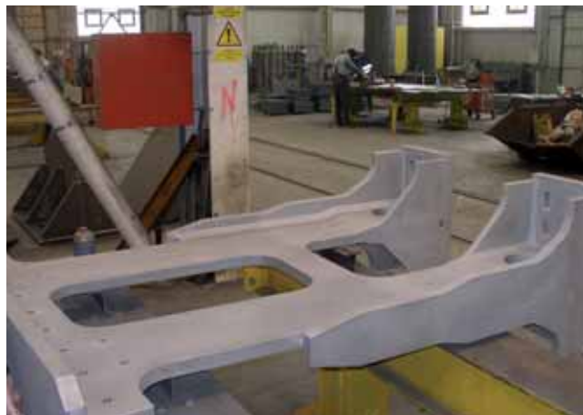
Obrázek 3: Ocelový kotevní přípravek zajišťující spojení příčníků/táhlo oblouku
