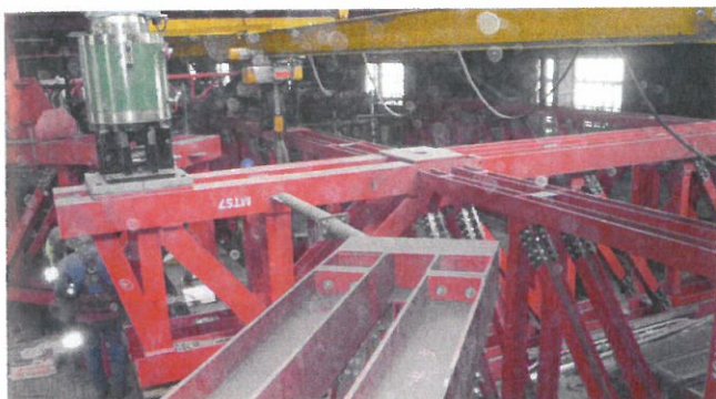
Obr. 12 – Nosník ve středu kotle s lisem na převislém konci
