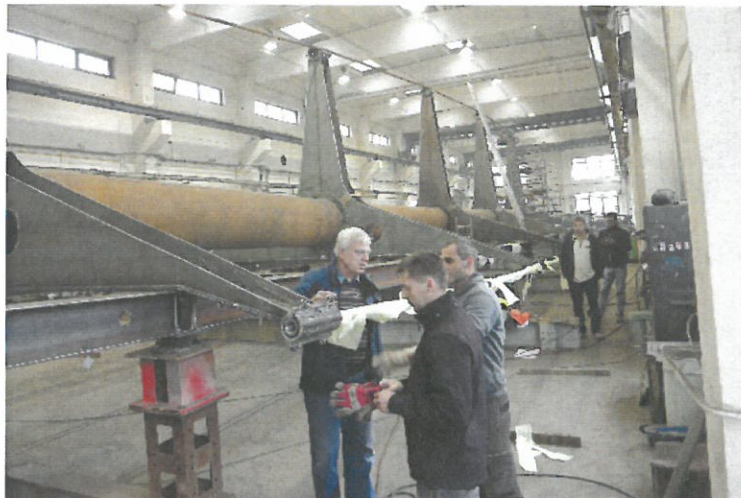
▲ Obr. 9. Předmontáž konstrukce v dílně
