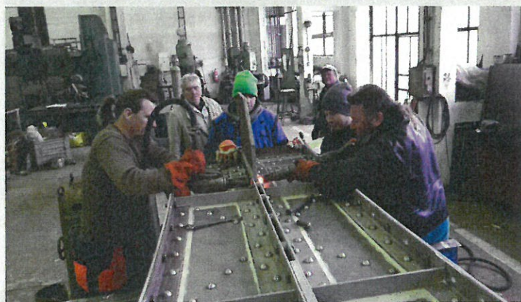
▲ Obr. 17. Nýtování sloupu 1B v dílně
