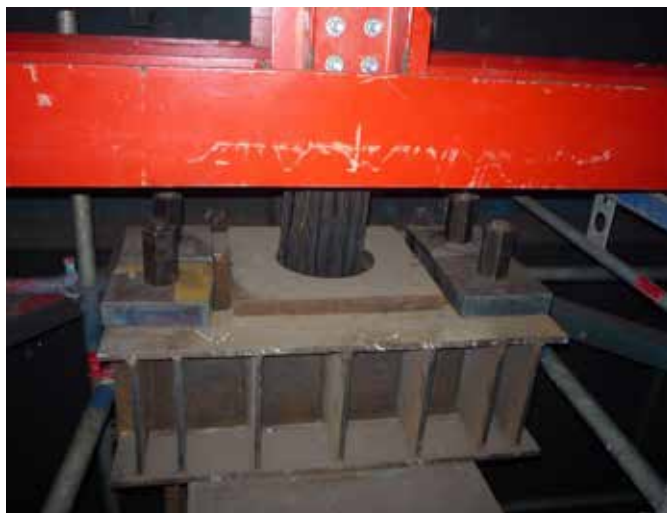
Obr. 31 Horní část objímky uchycení lan
