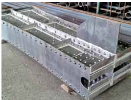
Obr. 20: Sloup po sestavení v dílně
