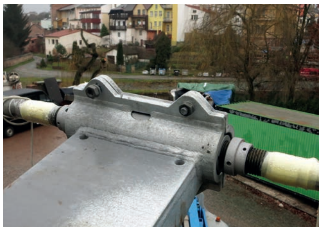
Tenzometrické měření táhel (Komenského most v Jaroměři)
