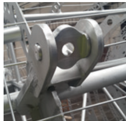
▲ Obr. 7 Kardanový závěs: část modelu
