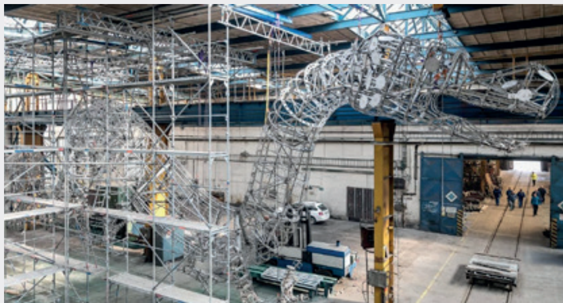
▼ Obr. 15 Smontovaná základní konstrukce draka
