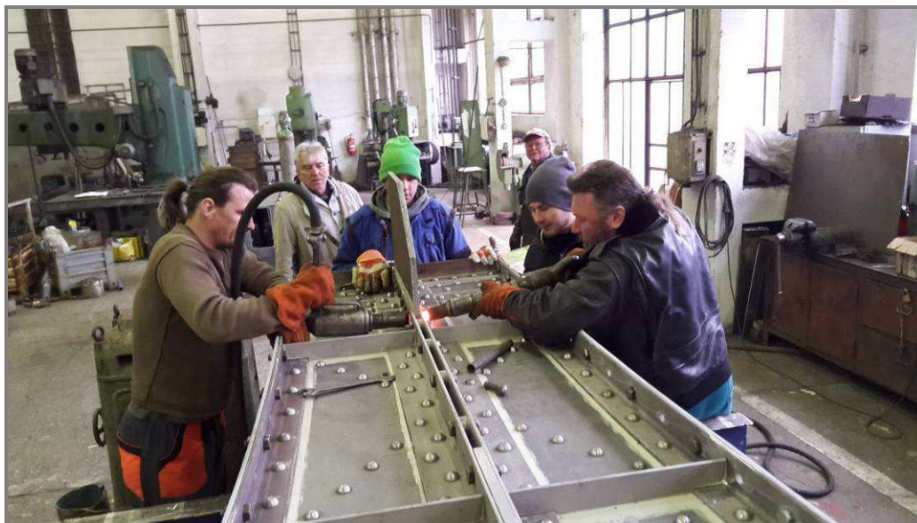
Obr. 27 Nýtování sloupu v dílně Figure 27 Column riveting in the workshop
