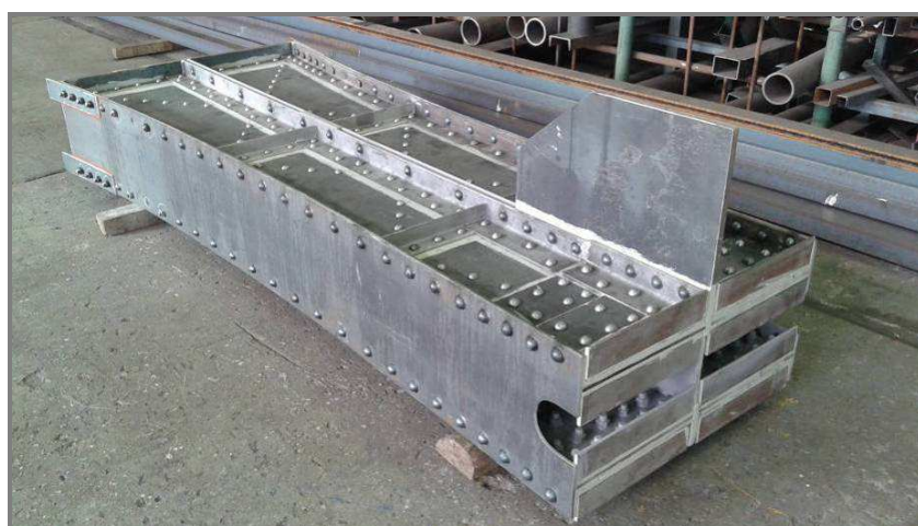
Obr. 28 Sloup po sestavení v dílně Figure 28 Column after assembly in the workshop
