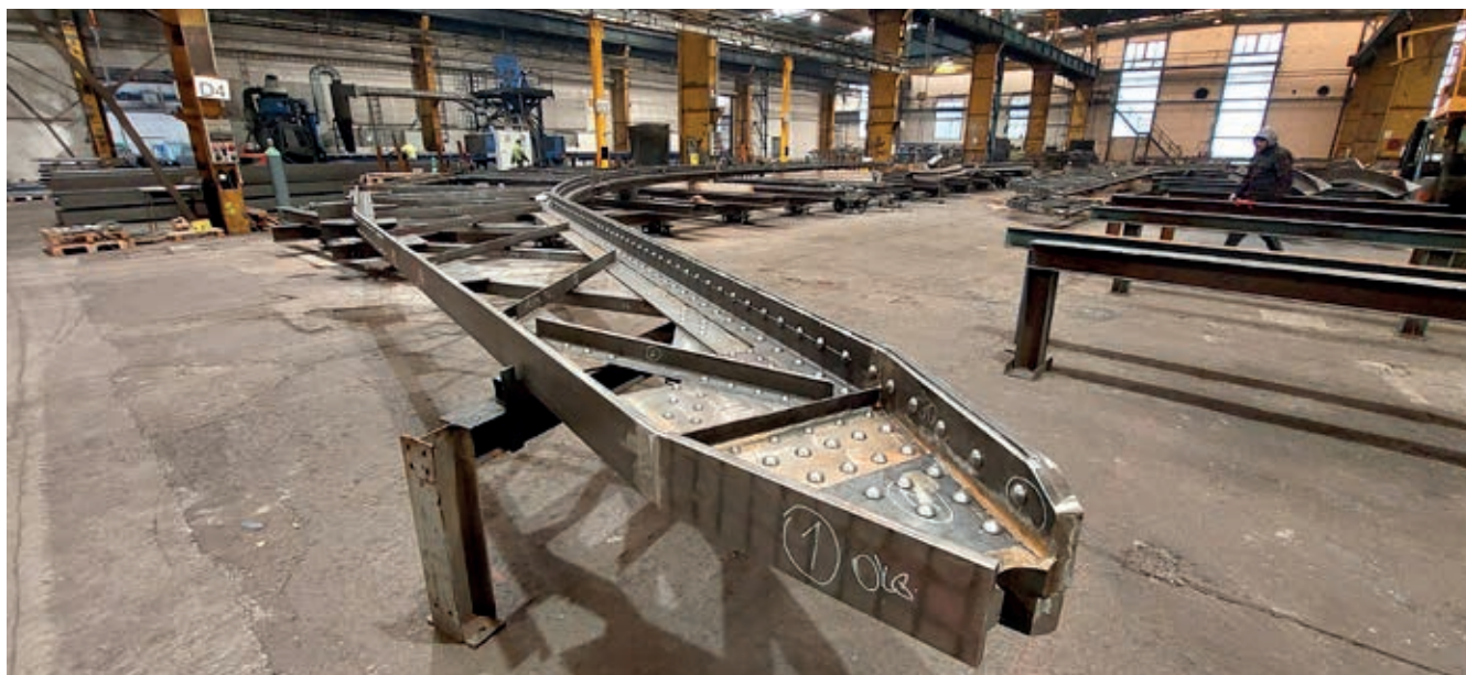
Obr. 3 – Dílenská sestava sloupu a příčle 1/2 rámu příčné vazby.
