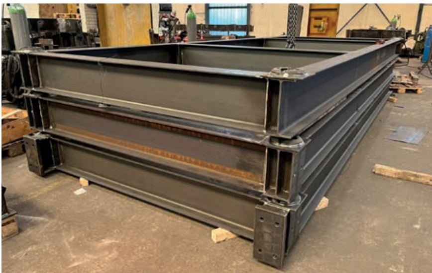
Rámová konstrukce pro montáž světlíků.
